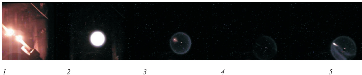
Рис. 3. Циклический процесс беспламенного горения капли горючего в воздухе в невесомости: 1 — зажигание (проводилось однократно); 2 — появление яркого желтого пламени; 3 — преобразование пламени в тусклое голубое свечение; 4 — исчезновение видимого пламени; 5 — повторное самовоспламенение (этапы 2–5 повторялись циклически до полного выгорания капли горючего)
