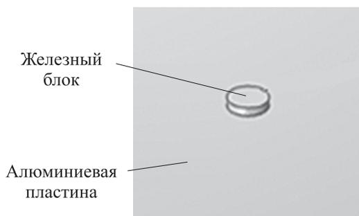
Рис. 2. Фрагмент структуры «суперматериала»
