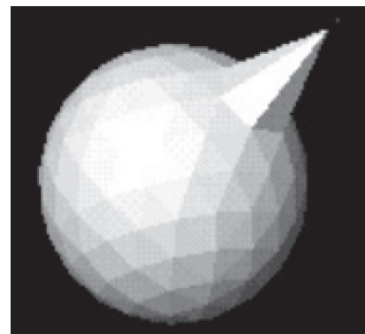
Рис. 3. Модель баллона, деформируемая точечным усилием
