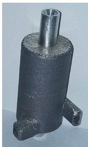
Рис. 4. Внешний вид образца ДСТ, изготовленного методом SLM-печати
