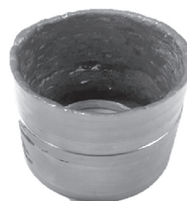
Рис. 4. Внешний вид цилиндрического образца, полученного методом ДАН, после токарной обработки
