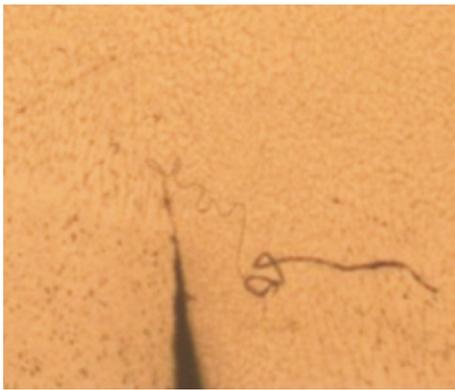
Рис. 4. Микрофотография включений оксидной пленки в СШ до эксперимента
