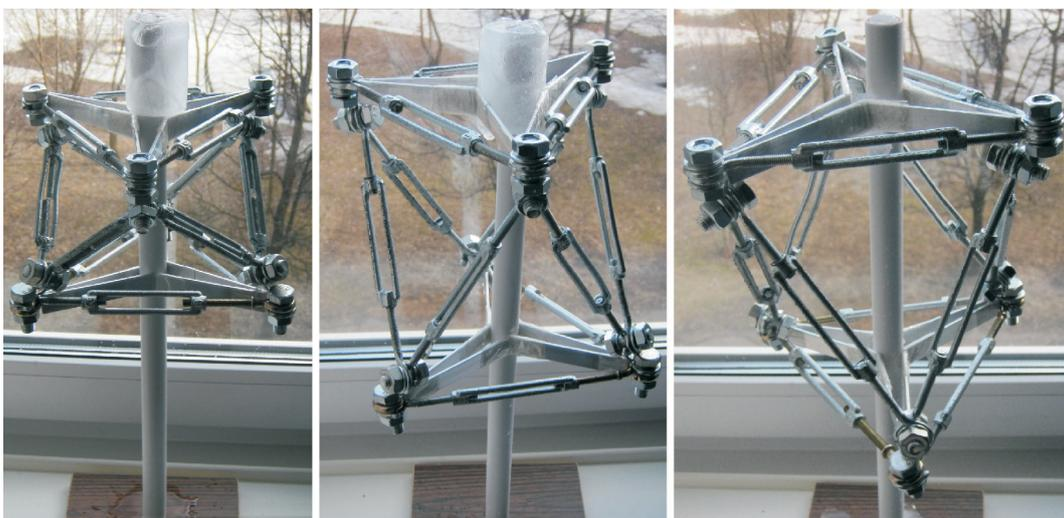
Рис. 7. Рабочий цикл кинематической силовой физической модели ВЛ на имитаторе ванты с участком наледи
