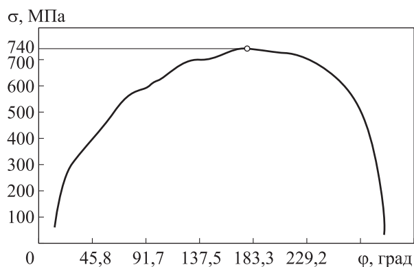
Рис. 4. Распределение контактного напряжения \sigma в одном зубе за один оборот эксцентрикового вала
