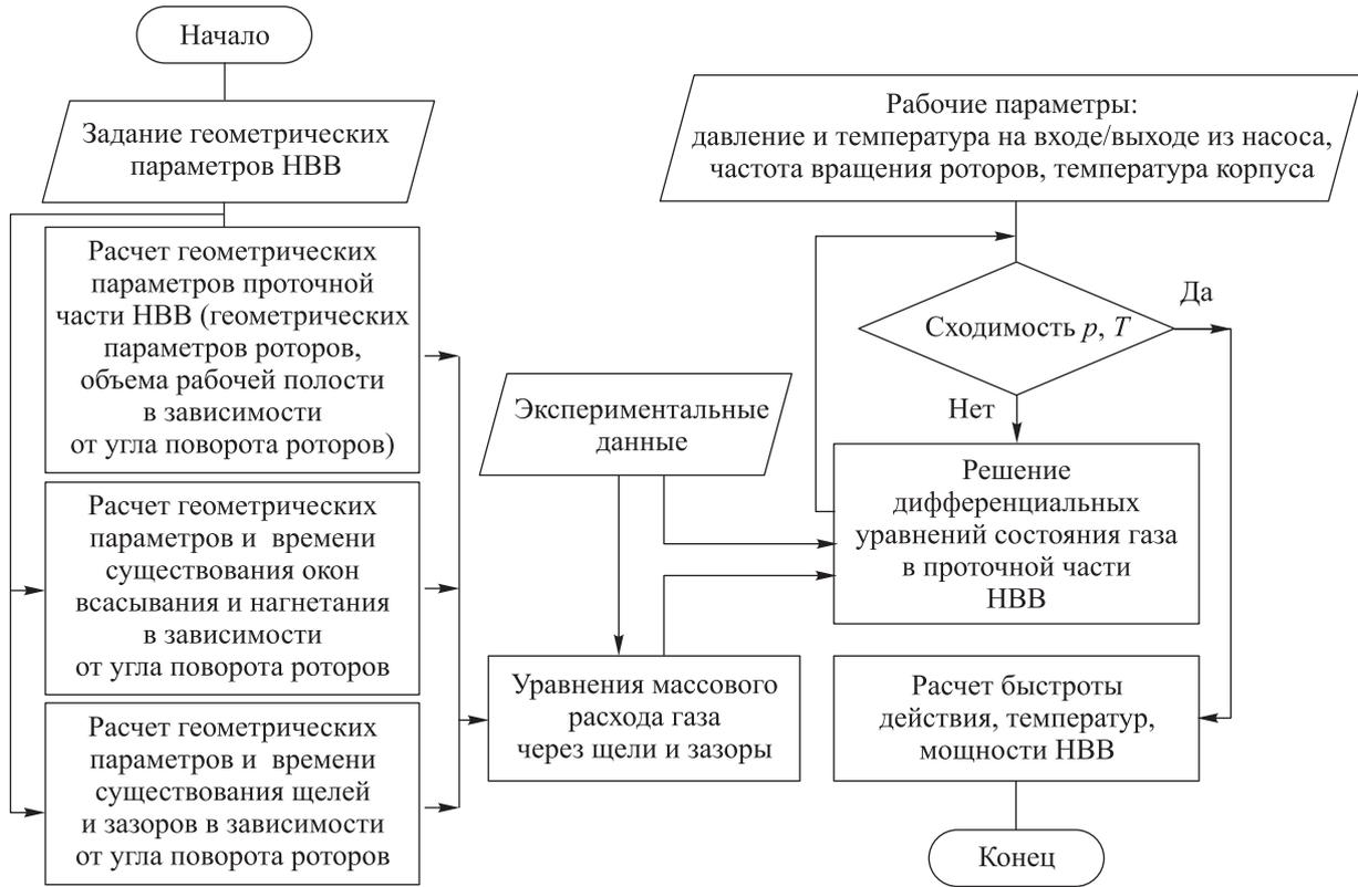
Рис. 2. Блок-схема математической модели рабочего процесса НВВ
