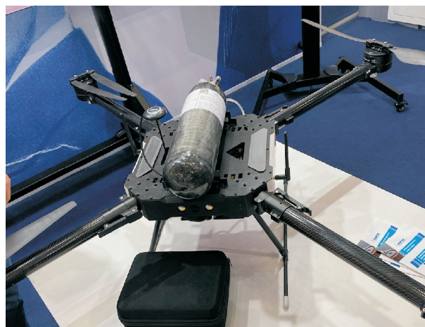
Рис. 2. Внешний вид водородного баллона ООО «Сафит» объемом 6,8 л, установленного на БПЛА
