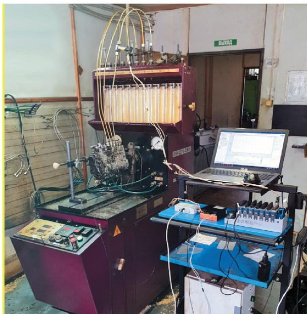
Рис. 1. Внешний вид стенда КИ-22210-02М-15 для испытания и регулирования топливной аппаратуры ТД
