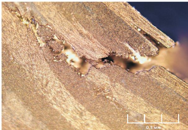
Рис. 7. Микроструктура образца с дефектами в области сгиба
