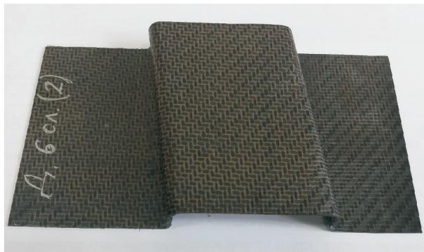
Рис. 4. Внешний вид кронштейна из углепластика на основе углеродной ткани и ПЭЭК
