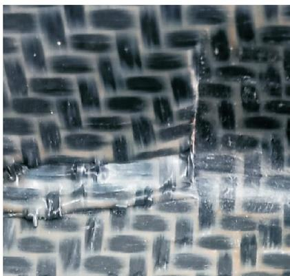
Рис. 5. Внешний вид листовой заготовки с дефектом в месте изгиба
