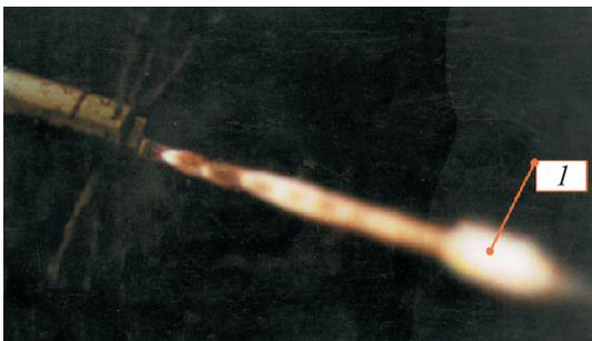
Рис. 2. Структура струи, истекающей из горелки
