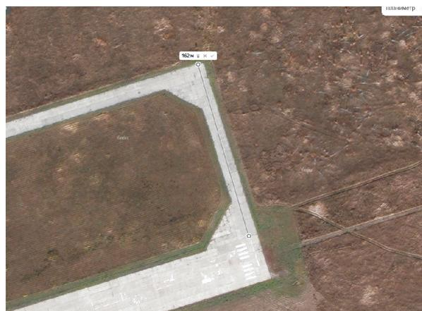
Рис. 2. Схема размещения датчика с ноутбуком для приема данных с указанием расстояния до взлетно-посадочной полосы
