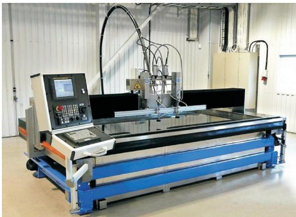
Рис. 1. Внешний вид станка гидроабразивной резки WJS NC4020E
