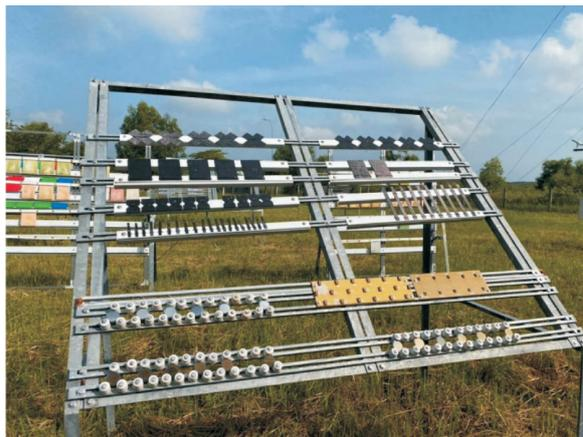
Рис. 2. Внешний вид стеллажа для экспонирования образцов
