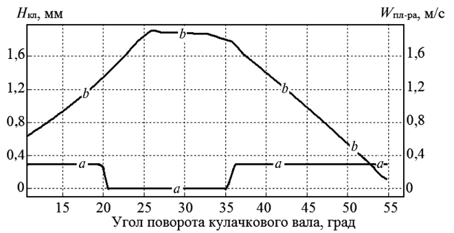
Рис. 3. Закон движения затвора клапана и зависимость скорости плунжера от угла поворота вала ТНВД:
