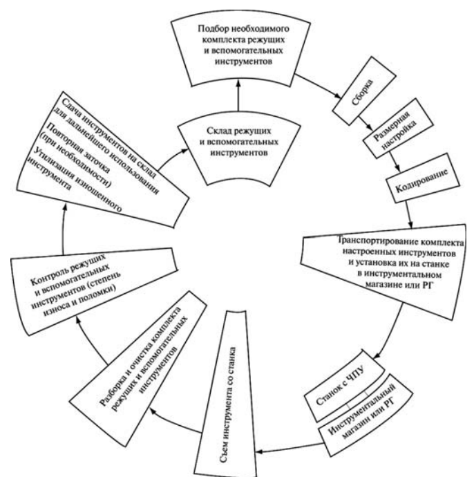
Рис. 1. Общая схема использования режущих инструментов на станках с ЧПУ
