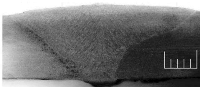
Рис. 5. Макроструктура шва, выполненного двухдуговой сваркой под флюсом
