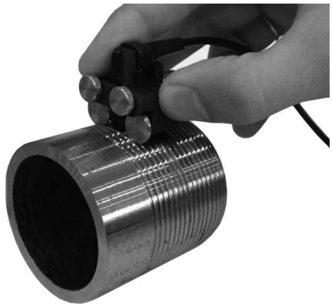
Рис. 6. Каретка ККТ1 с преобразователем на резьбе
