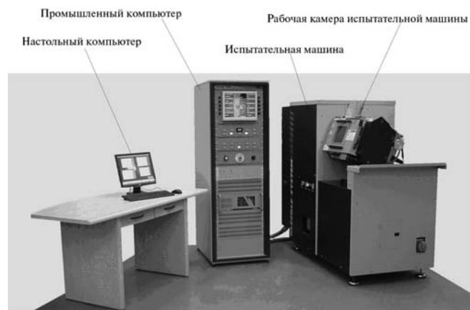
Рис. 1. Общий вид установки Gleeble-3800
