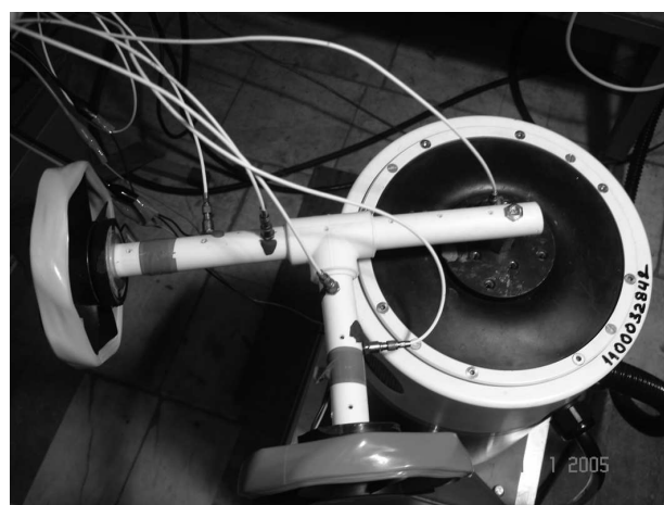
Рис. 3. Балочная упругая конструкция с двумя перпендикулярными роторами, консольно прикрепленная болтом к монтажной плите вибростенда
