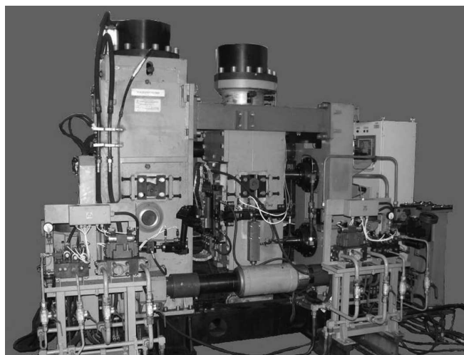
Рис. 2. Стационарная рельсосварочная машина для КССО
