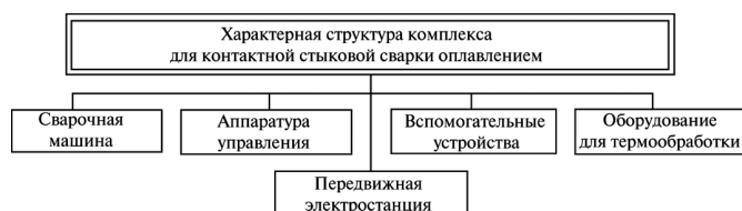
Рис. 1. Основные элементы структуры комплекса КССО
