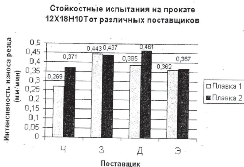
Рис 1. Результаты стойкостных испытаний* на заготовках 12X18H10T от различных поставщиков (Ч – Челябинск, З – Запорожье, Д – Днепропетровск, Э – Электросталь)
