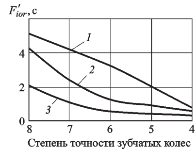
Рис. 6. Влияние степени точности зубчатых колес на КП передачи с самоустанавливающимся кулачком:
