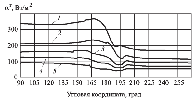
Рис. 6. Распределение коэффициента теплообмена по угловой координате ГЛА для разных значений продольной координаты Z :
