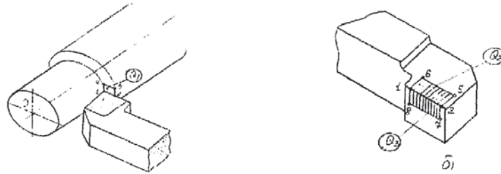
Рис. 1. Размещение площадок трения резца о деталь при резании металла. Вид (а) - на детали и (б) - на поверхностях режущего инструмента [1].
