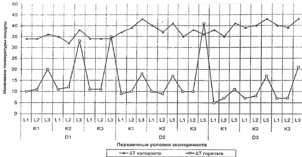
Рис. 1. Характеристика интенсивности температурного разделения при давлении сжатого воздуха на входе вихревой камеры 0,4 МПа
