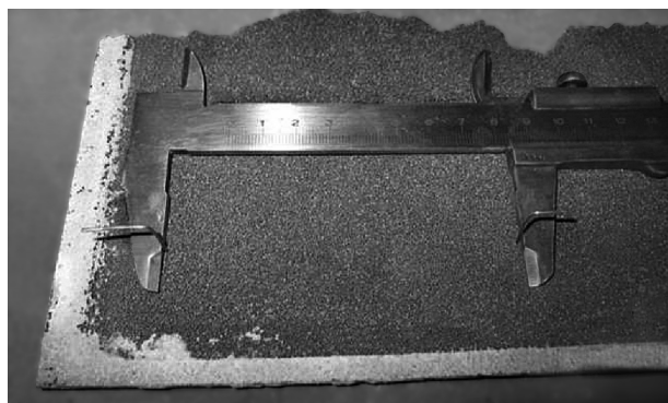
Рис. 3. Определение коэффициента линейного расширения
