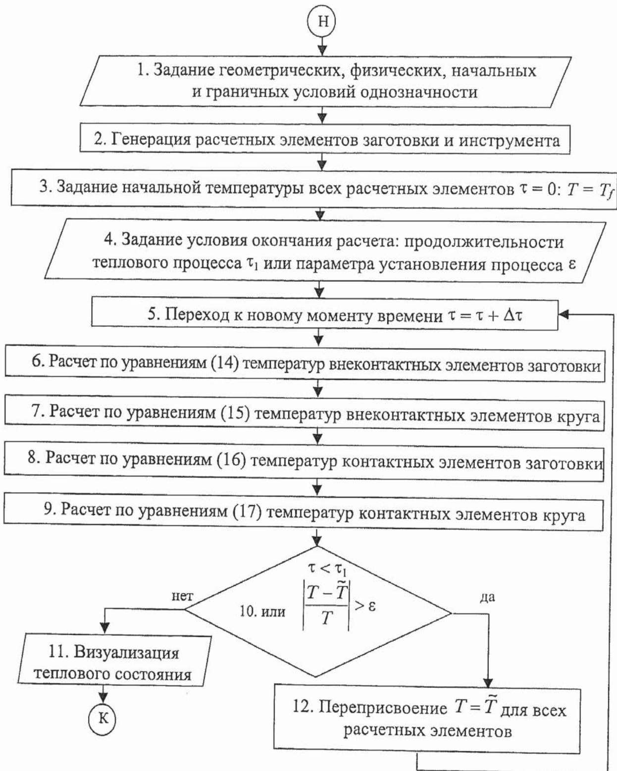
Рис. 3. Укрупненная блок-схема расчета температурных полей в заготовке и шлифовальном круге при шлифовании композиционными кругами
