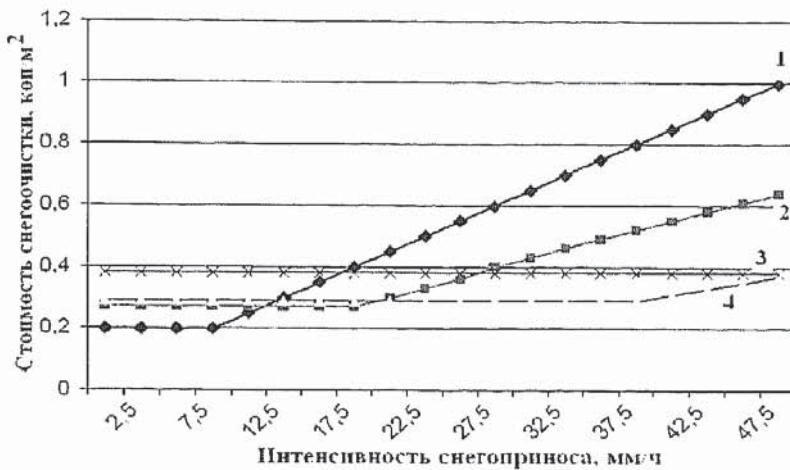
Рис. 2. Изменение стоимости снегоочистки от интенсивности снегоприноса на дорогу для коммунальных машин весом: 1 — 3 т; 2 — 5 т; 3 — 8 т; 4 — 15 т
